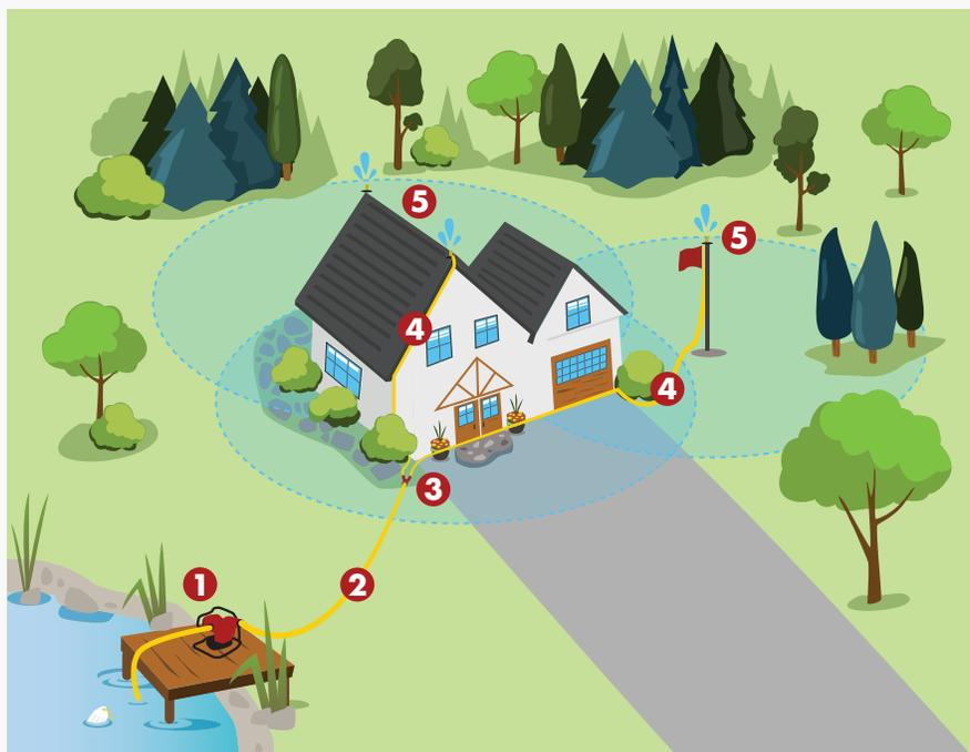
**Para cualquier configuración, los componentes y requisitos dependerán de la(s) estructura(s), el área de protección, elevación y la distancia de la fuente de agua y el volumen y presión de los rociadores. Una vez que los requerimientos son calculados, seleccionar que motobomba ofrece el rendimiento necesario.**
